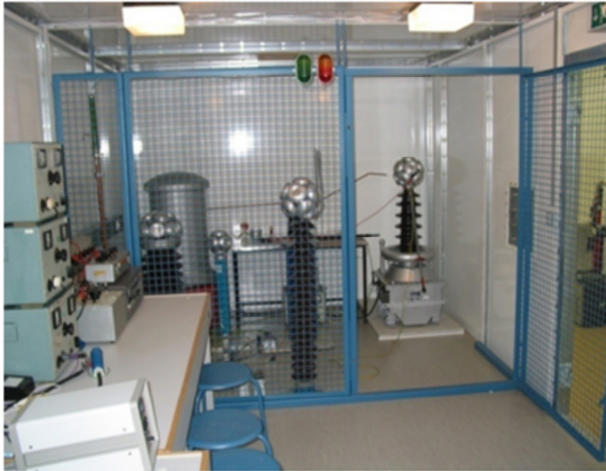
Abbildung: Geschirmte Messkabine zur Teilentladungs- und Verlustfaktormessung
