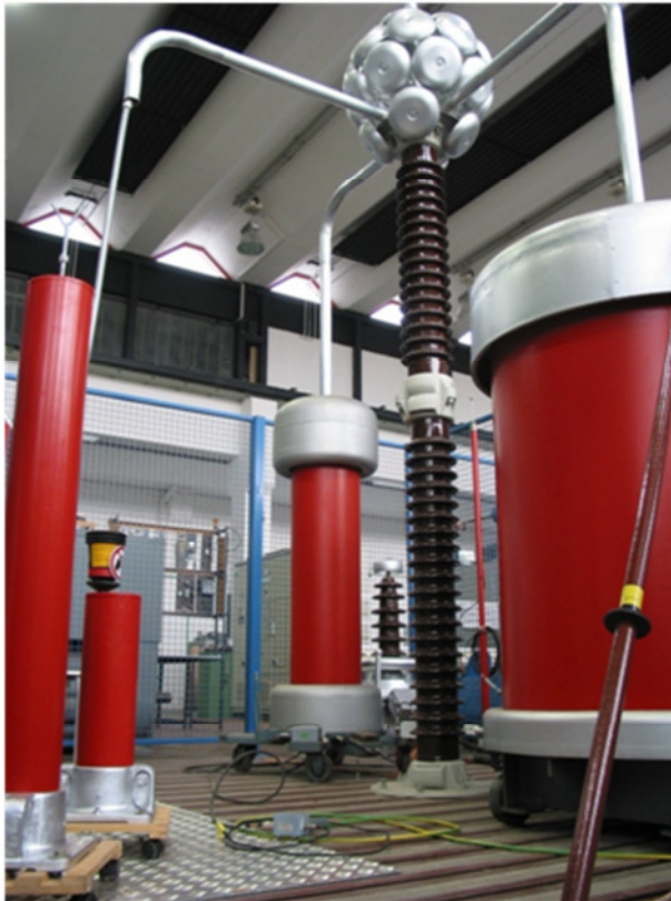
Abbildung: Wechselspannungs-Prüfsystem zur Erzeugung von Wechselspannungen bis 200 kV
